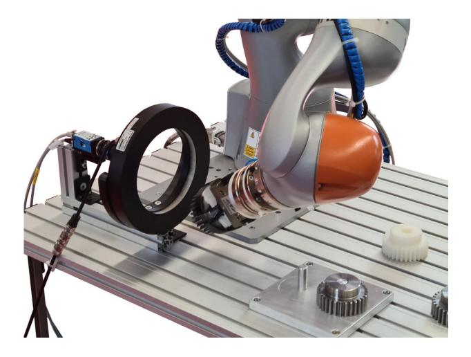
Xeidana confirms that the robot has gripped the correct gear. Credit: Fraunhofer-Institut für Werkzeugmaschinen und Umformtechnik IWU
